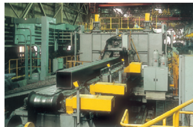
20インチミルのミーリング方式走行切断機 Structural Column Section Emerging from Milling Cutter on the 20-inch Mill Line
