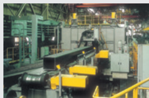
20インチミルのミーリング方式走行切断機
