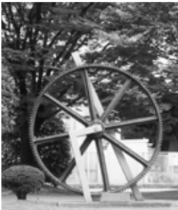
丸一製作所時代のドローベンチのメインギア (直径約1.8m)
