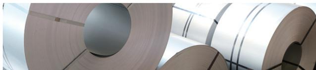
鋼板を酸洗し、冷間圧延、溶融亜鉛めっきで仕上げを行い、耐食性と外観に優れた鋼板を製造しています。
